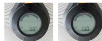
Dès que le temps de cuisson enregistré est écoulé, la fonction de maintien de la chaleur s'active. Cela signifie que votre plat est maintenu à une température de 60 °C pendant une heure.
